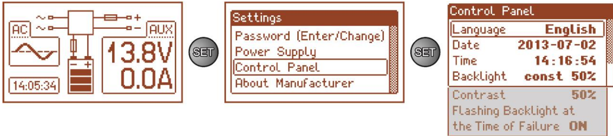
Fig. 23. „Control panel” screen.
